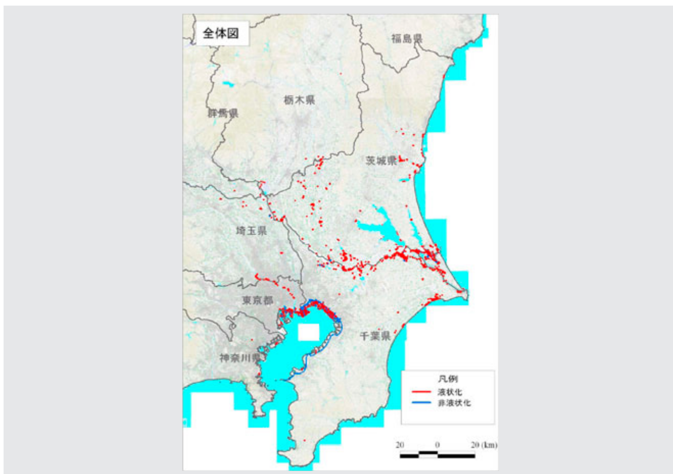
図2.4-1 関東地方で液状化が発生した地点の分布 2)
