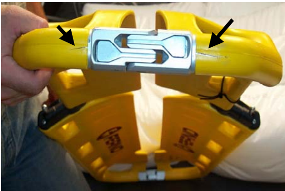
試験に使用したヒンジ部に亀裂のある スクープエクセル
