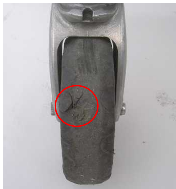
ホイールの削れと剥離が発生している
