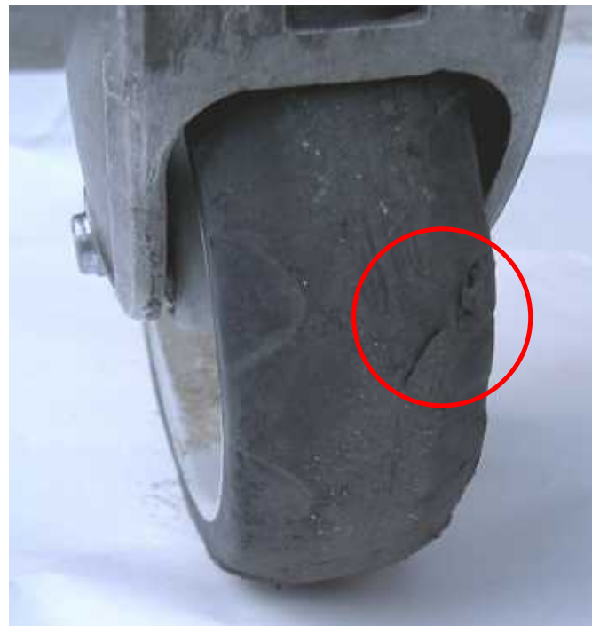
ホイールの剥離が発生している
