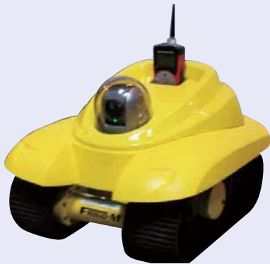
可燃性ガス・有毒ガス等を検出して危険を知らせるロボット Robot that detects and notifies of flammable and toxic gases
