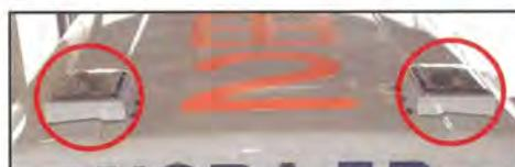
⑦ バックボード積載用収納架台
