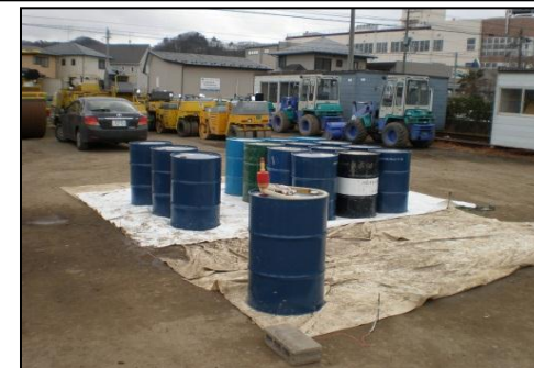
空き地にドラム缶で危険物を貯蔵している様子
