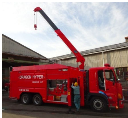
大容量送水ポンプ車 (スーパーポンパー)
