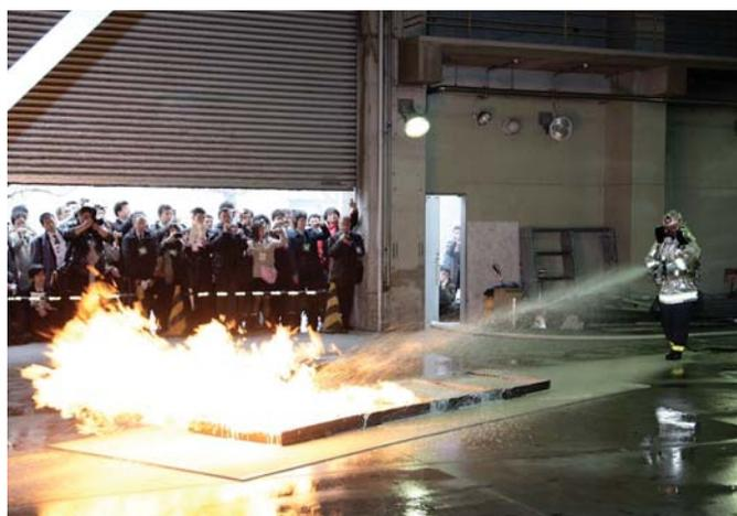
写真3 2流体ノズルを用いた可燃性液体火災の消火実験
