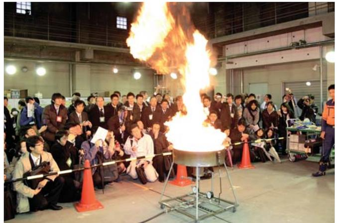
写真1 泡消火剤による小規模石油タンク火災の消火実験
