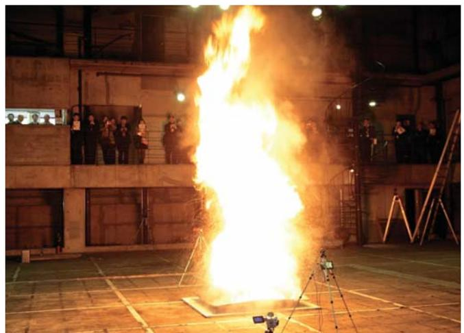
写真2 バイオディーゼルの燃焼実験
