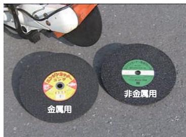
図 3.3 研削ブレードの選定
