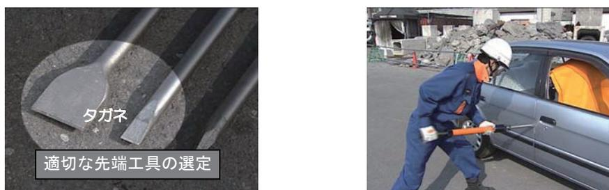
図 5.5 車両ドアの開放作業
