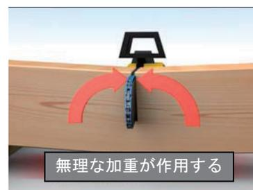
図 4.6 切断刃の挟み込み
