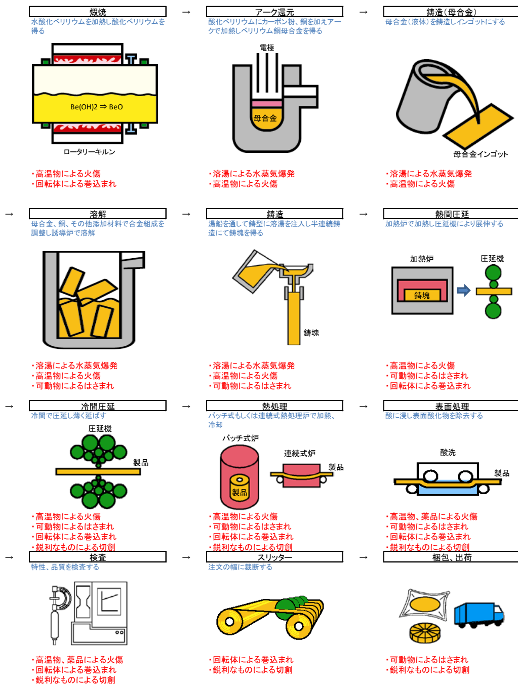
〔図Ⅱ-11-11 ベリリウム製造フローと主な潜在危険性（ハザード）（ベリリウム銅合金展伸材）〕
