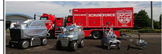
5. 無人自動放水消火ロボット(例)
