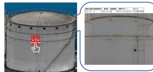
図3 SfMによる3D化+点検記録管理
