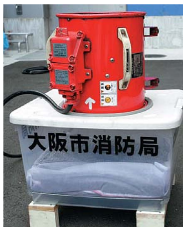
図1 大阪市消防局の簡易型硫化水素除去装置(外観)
