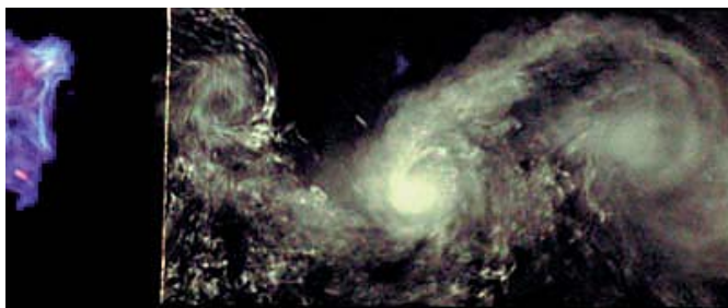
写真2 直径90cmの容器内のメタノール火炎風下に発生する火災旋風。左から右に風を吹かせている。 上：横から撮影。下：下から撮影。
