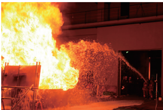
模擬タンク火災泡消火の様子
