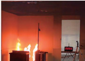
A fire suppression experiment with new sprinklers for small sized welfare facilities. 小規模な福祉施設に対応した新たなスプリンクラーの消火実験
