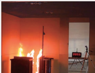
小規模な福祉施設に対応した新たなスプリンクラーの消火実験
