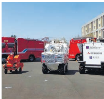
試作した消防ロボットシステムの各単体ロボット
