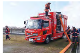
海水利用型消防水利システム
