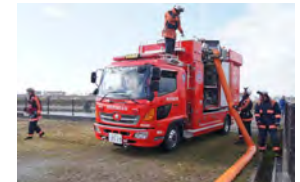
海水利用型消防水利システム
