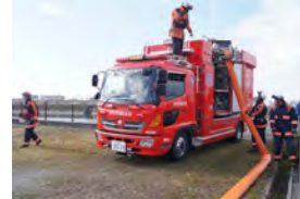
海水利用型消防水利システム
