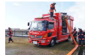
海水利用型消防水利システム
