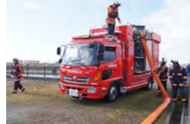
海水利用型消防水利システム
