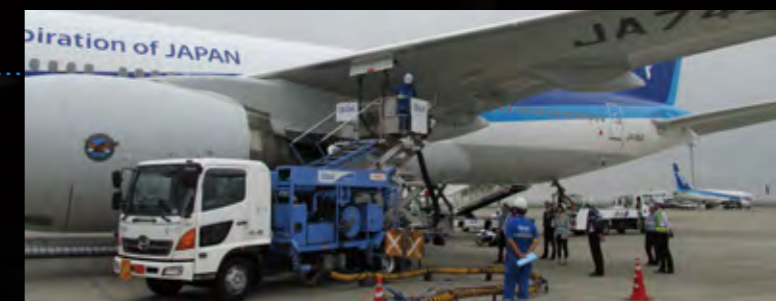
空港にて給油作業を視察
