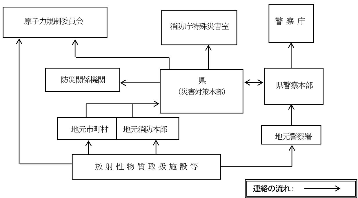
図2 運搬中の事故に伴う放射性物質の漏洩時等に係る情報連絡系統
