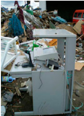
写真3.5-12 津波で破損した関上出張所の受令台 1)
