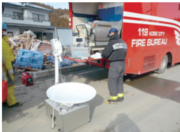
写真4.6-73 可搬型衛星地球局による連絡体制の確保(兵庫県隊) 1)
