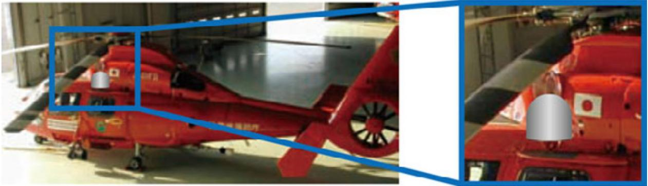
写真6.3-7 ヘリサットアンテナの搭載状況
