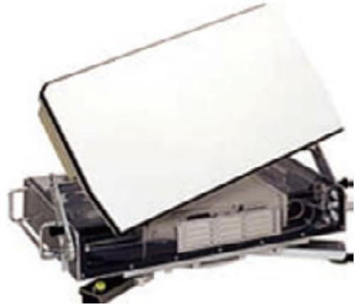
写真6.3-9 可搬型衛星地球局 (VSAT)
