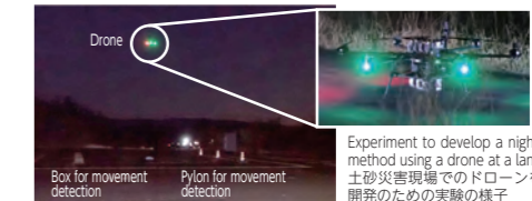
Drone Box for movement detection Pylon for movement detection Experiment to develop a night-time topographic measurement method using a drone at a landslide disaster site. 土砂災害現場でのドローンを用いた夜間の地形計測手法の開発のための実験の様子
