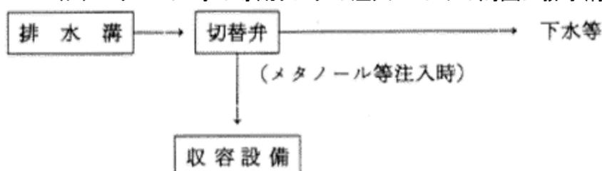
(イ) メタノール等の専用タンクの注入口及びメタノール等以外の専用タンクの注入口の周囲に排水溝を設ける場合
