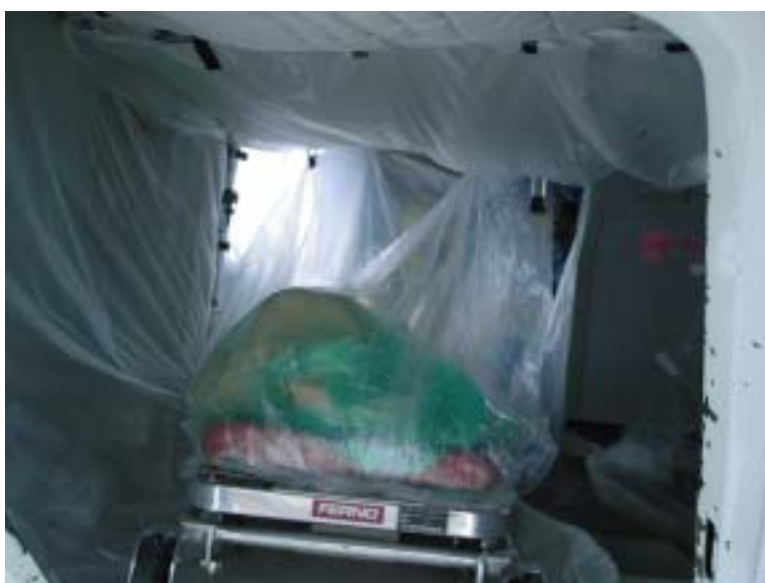
写真 ヘリコプター内壁の防護状態と、ストレッチャー上の患者が天幕よりのビニールにより2重に被覆されている状態
