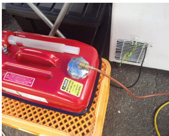
写真2 ガソリン携行缶とビニール製の配管の接続状況
