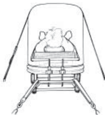
図②アイソレータをヘリコプター内に搬入した状態。 ここではベルトにより固定されている。
