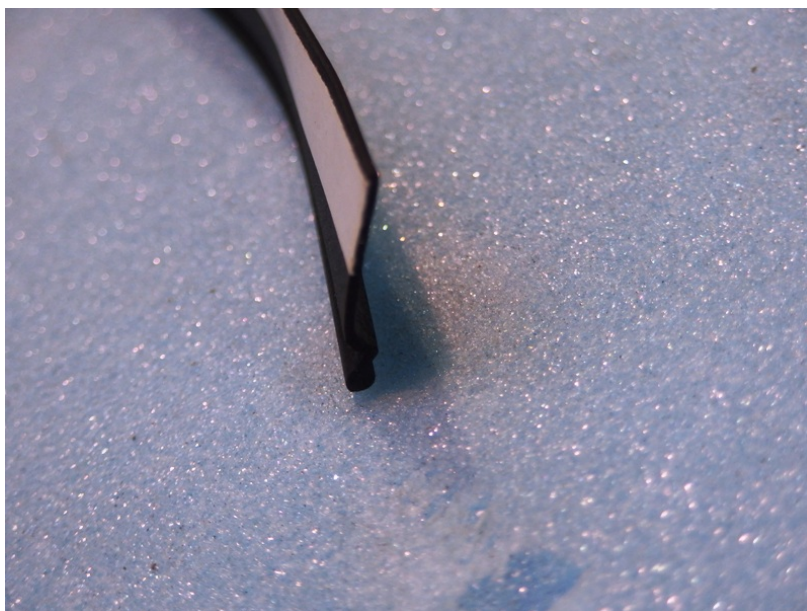
使用した気密ゴム (材質 気密ゴム：ピンチブロック #38-PS)
