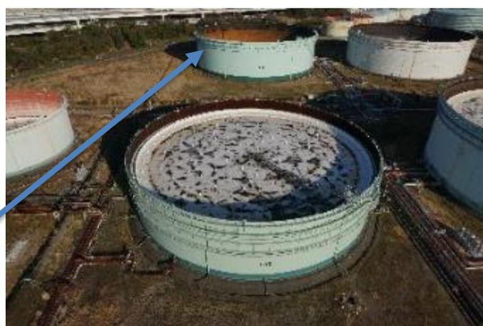
同じタンクを180度異なる角度から撮影した画像。左の画像からかなり浮屋根が沈みこんでいることが確認できる。そのため右の画像のように水平距離が離れてしまうと、高度を確保しても浮屋根を撮影することが困難である（右図参照）。
