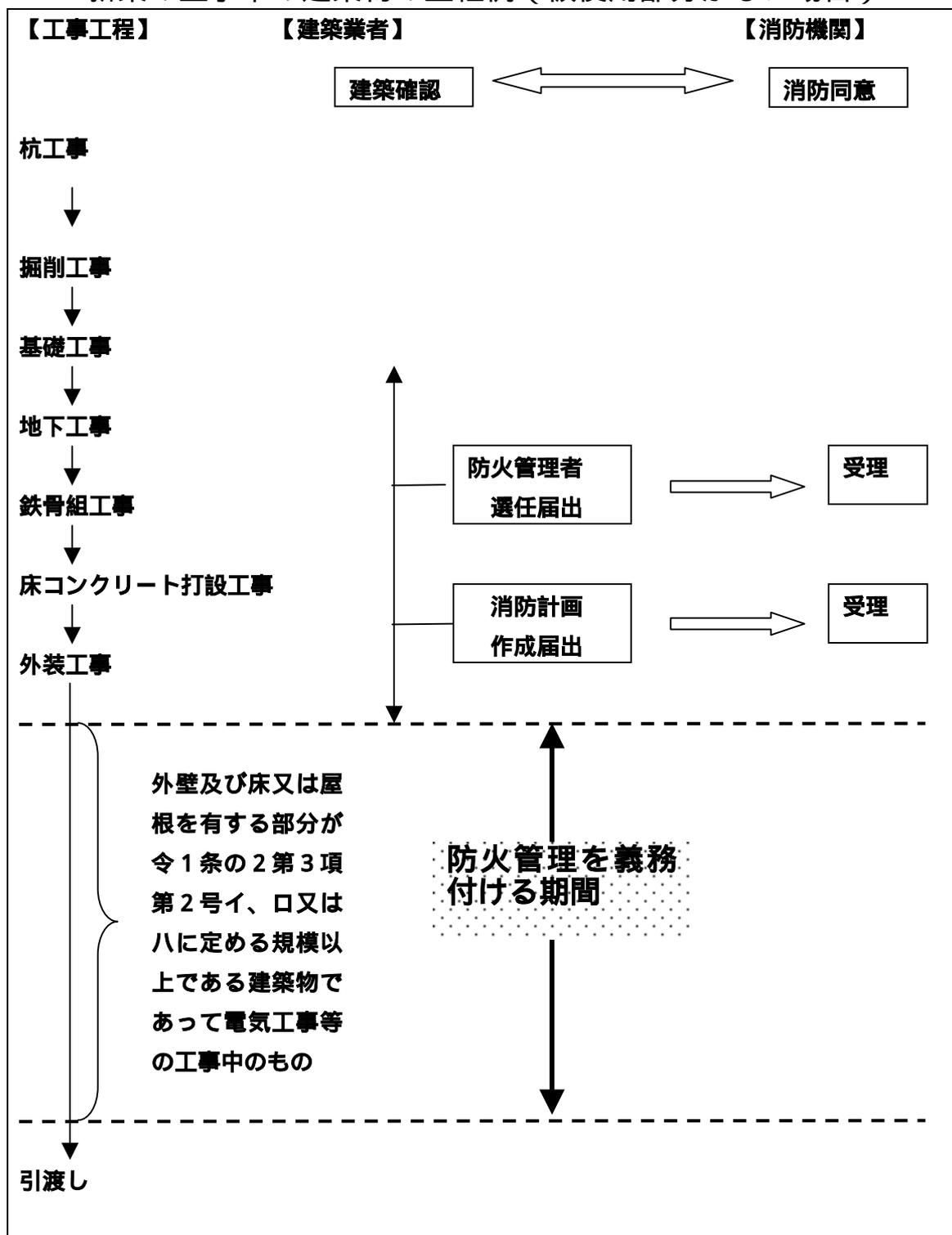
新築の工事中の建築物の工程例（仮使用部分がある場合）
