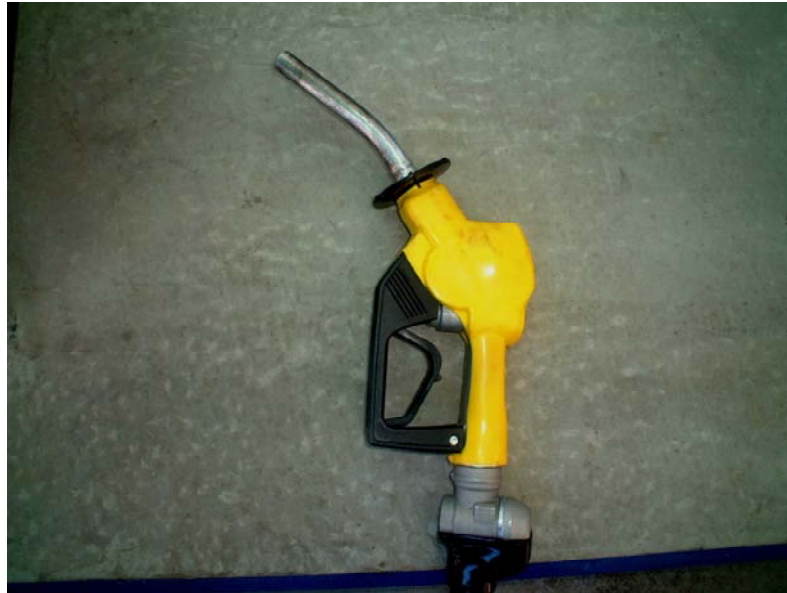
図 4-3 当該事故のノズル（拡大図）
