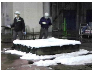
写真 74 耐火試験: 自然消火 OK
