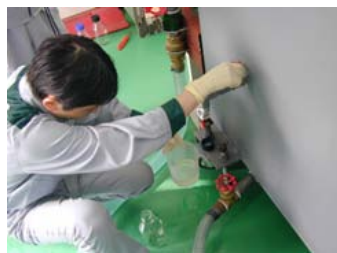
No. 22 バイオマス燃料(ETBE)グリッド及びE3の 油分層槽の排水に関する検証試験 試験状況 (ETBE 流速30L) ■通水前の採取配管内排 水
