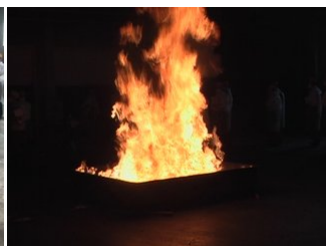
写真 84 耐火試験: 全面燃焼 NG 5分後強制消火
