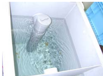
No. 11 バイオマス燃料(ETBE)及びE3の 油分離槽の排水に関する検証試験 試験状況(E3 流速90L) ■通水直後の第3槽の水面(油膜無し)
