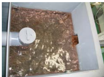
No. 31 バイオマス燃料(ETBE)及びFE3の 油分離槽の排水に関する検証試験 試験状況(ETBE 流速60L) ■ETBE含有がリン3cm通水 直後の第1槽の水面
