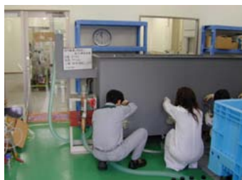
No. 27 バイオマス燃料(ETBE)及びFE3の 油分離槽の排水に関する検証試験 試験状況(ETBE 流速30L) ■1.2m通水後の各槽の試料採取
