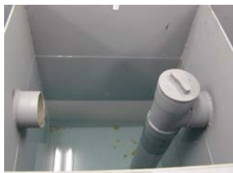
No. 15 バイオマス燃料(ETBE)グリッド及びE3の 油分層槽の排水に関する検証試験 試験状況 (E3 流速90L) ■通水終了後の第3槽の水 面(油膜無し)
