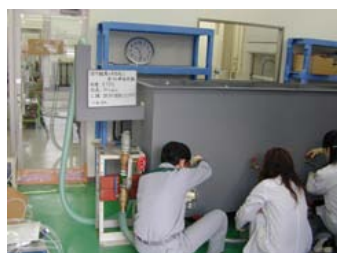
No. 24 バイオマス燃料(ETBE)グリッド及びE3の 油分層槽の排水に関する検証試験 試験状況 (ETBE 流速30L) ■0.3m通水後の各槽の試 料採取
