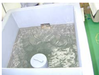
No. 9 バイオマス燃料(ETBE)及びE3の 油分離槽の排水に関する検証試験 試験状況(E3 流速90L) ■通水直後の第1槽の水面
