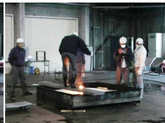
写真10 耐火試験: 不消火 NG 5分後強制消火
