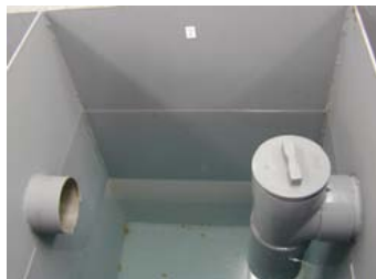
No. 14 バイオマス燃料(ETBE)グリッド及びE3の 油分層槽の排水に関する検証試験 試験状況 (E3 流速90L) ■通水終了後の第2槽の水 面(油膜有り)
