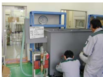
No. 25 バイオマス燃料(ETBE)及びFE3の 油分離槽の排水に関する検証試験 試験状況(ETBE 流速30L) ■0.6m通水後の各槽の試料採取
