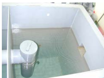
No. 13 バイオマス燃料(ETBE)グリッド及びE3の 油分層槽の排水に関する検証試験 試験状況 (E3 流速90L) ■通水終了後の第1槽の水 面(表面にカソリが残る)
