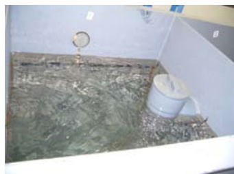
No. 34 バイオマス燃料(ETBE)及びFE3の 油分離槽の排水に関する検証試験 試験状況(カリン 流速90L) ■通水直後の第1槽の水面
