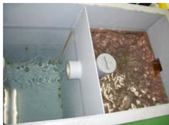
No. 32 バイオマス燃料(ETBE)及びFE3の 油分離槽の排水に関する検証試験 試験状況(ETBE 流速60L) ■ETBE含有がリン3cm通水 直後の第1槽、2槽の水面
