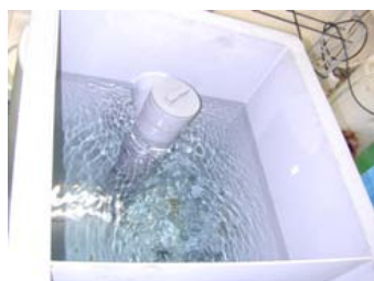
No. 12 バイオマス燃料(ETBE)及びE3の 油分離槽の排水に関する検証試験 試験状況(E3 流速90L) ■通水直後の第4槽の水面(油膜無し)
