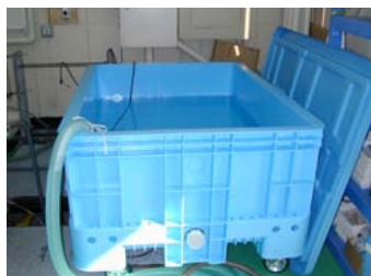
No. 2 バイオマス燃料(ETBE)及びE3の 油分離槽の排水に関する検証試験 試験装置概要 ■1KL水槽 ※水中ポンプにより貯水を分離槽へ注水します。
