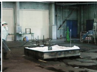
写真 44 耐火試験: 自然消火 OK
