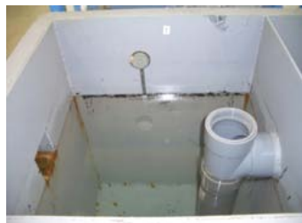
No. 35 バイオマス燃料(ETBE)及びFE3の 油分離槽の排水に関する検証試験 試験状況(カリン 流速90L) ■通水終了後の第1槽の水 面(表面にカリンが残る)
