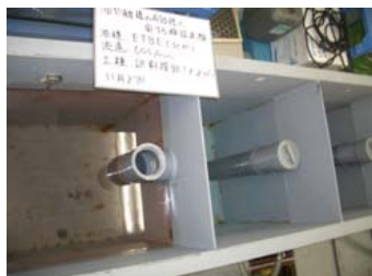
No. 33 バイオマス燃料(ETBE)及びFE3の 油分離槽の排水に関する検証試験 試験状況(ETBE 流速60L) ■ETBE含有がリン3cm通水 終了後の水面
