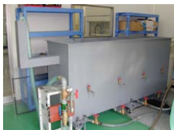
No. 1 バイオマス燃料(ETBE)及びE3の 油分離槽の排水に関する検証試験 試験装置概要 ■油分離槽(4層)と流量調整装置(左側手前) ※左側上部より注水します。
