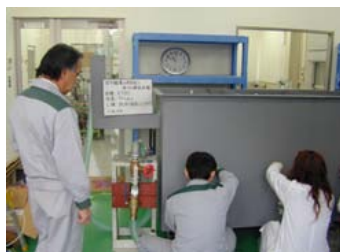
No. 26 バイオマス燃料(ETBE)及びFE3の 油分離槽の排水に関する検証試験 試験状況(ETBE 流速30L) ■0.9m通水後の各槽の試料採取
