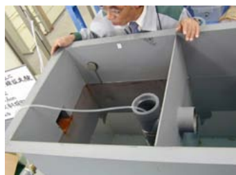
No. 28 バイオマス燃料(ETBE)及びFE3の 油分離槽の排水に関する検証試験 試験状況(ETBE 流速30L) ■通水後の第1槽パイプ内の試料採取
