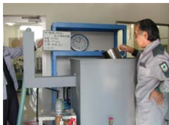
No. 20 バイオマス燃料(ETBE)グリッド及びE3の 油分層槽の排水に関する検証試験 試験状況 (ETBE 流速30L) ■試験準備: 水面に3.6L注 入
