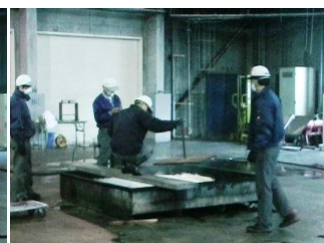
写真20 耐火試験: 不消火 NG 5分後強制消火
