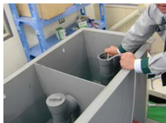
No. 29 バイオマス燃料(ETBE)及びFE3の 油分離槽の排水に関する検証試験 試験状況(ETBE 流速30L) ■通水後の第4槽パイプ内の試料採取
