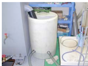
No. 4 バイオマス燃料(ETBE)及びE3の 油分離槽の排水に関する検証試験 試験装置概要 ■排水槽 ※分離槽から排出される水を一時貯めます。
