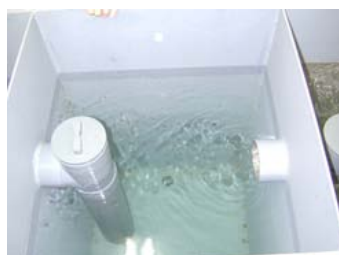
No. 10 バイオマス燃料(ETBE)及びE3の 油分離槽の排水に関する検証試験 試験状況(E3 流速90L) ■通水直後の第2槽の水面(若干油膜有り)
