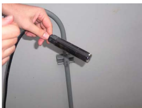
写真 3-1-16 土中センサー （ベーパータイプ）検知部
