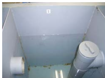
No. 36 バイオマス燃料(ETBE)及びFE3の 油分離槽の排水に関する検証試験 試験状況(カリン 流速90L) ■通水終了後の第2槽の水 面(油膜有り)
