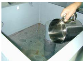
No. 21 バイオマス燃料(ETBE)グリッド及びE3の 油分層槽の排水に関する検証試験 試験状況 (ETBE 流速30L) ■ETBEグリッド3.6L注入後 の第1槽水面状態
