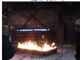
写真 72 耐火試験： 全面燃焼
