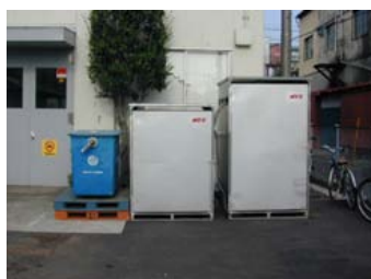
No. 7 バイオマス燃料(ETBE)及びE3の 油分離槽の排水に関する検証試験 試験装置概要 ■浄化装置 ※1KL地下タンクの貯水を浄化後、敷地内の分離槽へ排出します。
