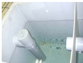
No. 16 バイオマス燃料(ETBE)グリッド及びE3の 油分層槽の排水に関する検証試験 試験状況 (E3 流速90L) ■通水終了後の第4槽の水 面(油膜無し)
