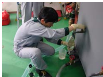
No. 23 バイオマス燃料(ETBE)グリッド及びE3の 油分層槽の排水に関する検証試験 試験状況 (ETBE 流速30L) ■通水前の第1槽の試料採 取
