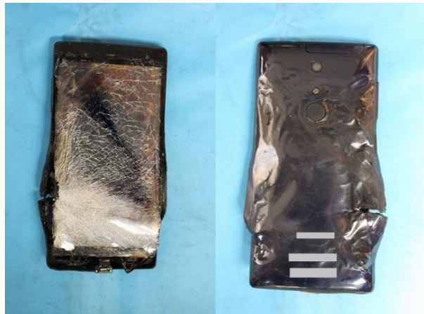
写真 2-2 スマートフォンの焼損状況
