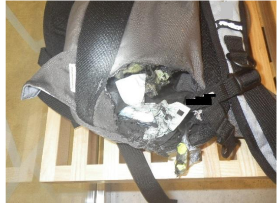
写真3-2 リュックの焼損状況
