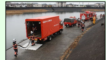
常備消防による遠距離送水システムの設定
