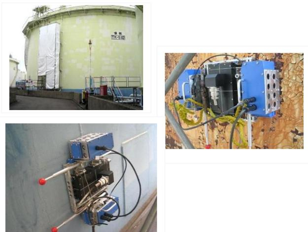
図6. 新型自走装置の実物タンク側板での走行性能テスト
