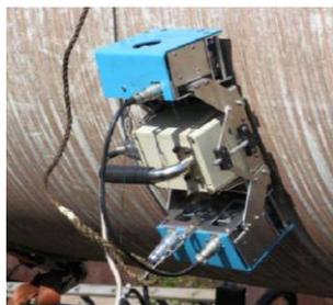
図1. 従来の腐食減肉診断装置(JFEグループ)
