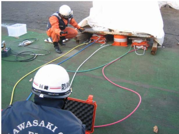
図10 空圧ピラーによる開口部拡張と確保
