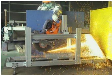
図6-1 エンジンカッターによる切断状況
