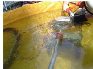
図 9-2 水中での切断確認
