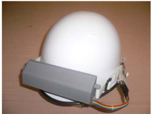
図6 ヘッドマウントディスプレイの実装
