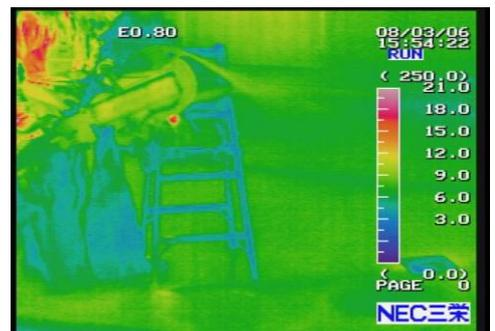
図7-2 高圧水駆動カッターによる切断時 赤外線カメラ映像 (冷却水放射)
