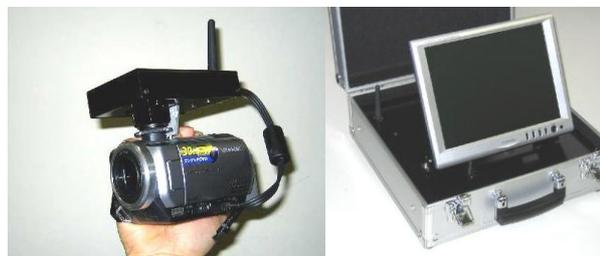
図.12 FDM方式映像伝送装置(左:送信機,右:受信機)
