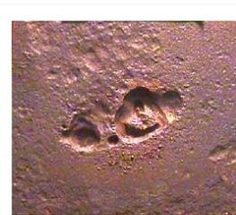
図7.1 φ20mm程度のアバタ状の腐食
