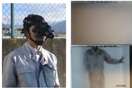
図.16 伝送映像 (左:ヘッドマウント型熱画像カメラ 右上:煙内通常 右下:煙内熱画像)
