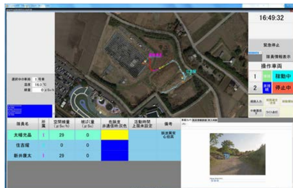
図.16 現場指揮本部の危険度警告システム 生体センサ情報から隊員の危険度が変化（演習時に生体センサ模擬訓練用実験端末を使用したもの）
