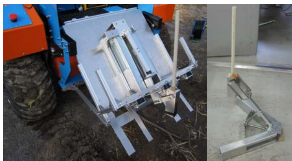
図.29 必要に応じて無線中継器を射出(初号機仕様) (最終機では小型軽量化し車体下への装着を想定)
