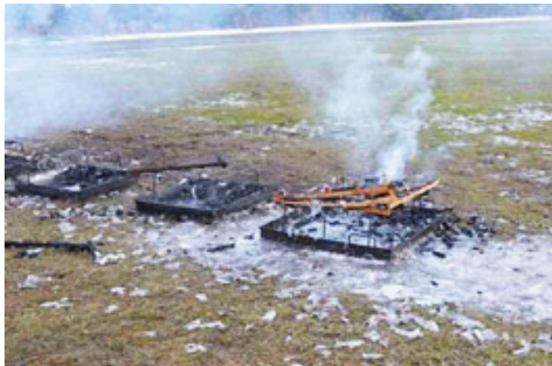
写真.14 ゲルパック消火剤による消火結果
