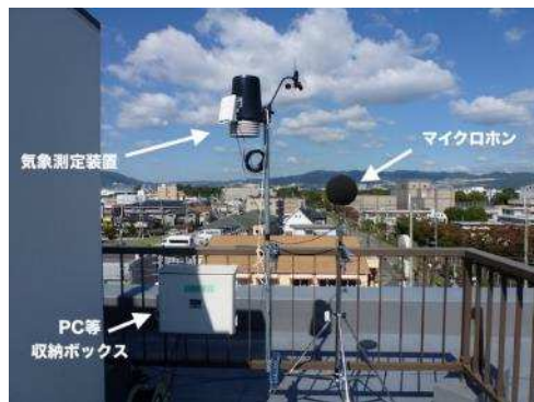
図 3-2 測定装置の設置例（測定点 2）
