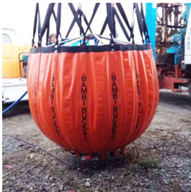
写真.8 満水にした状態での漏水試験
