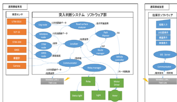
図.17 突入判断システムのソフトウェア群構成図
