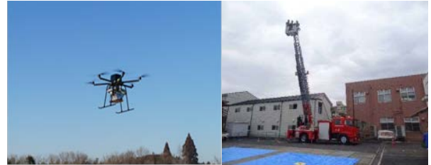
写真.4 UAV 及び梯子車による投下試験
