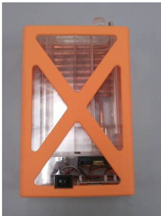
写真． 5 ヘッドイモビライザー型小型灌流装置のデザイン素案（平成 26 年度） ヘッドイモビライザー内に灌流装置を埋め込むことで搬送時の運用効率が大きく改善した。
