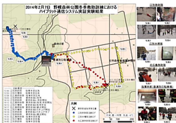
図.7 暴風雪時捜索を想定した実証実験結果 (2014年2月7日実施)
