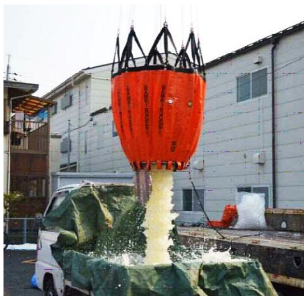
写真.9 吊下げ状態での投下試験
