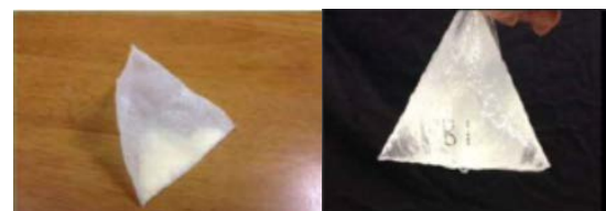
写真.2 パック材（左：乾燥状態 右：吸水状態）
