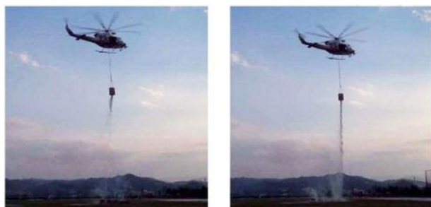
写真.15 水とゲルパック消火剤の落下状況
