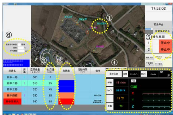
図.30 活動状況のモニタリング及び撤退判断画面
