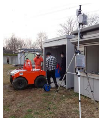
図.26 基地局の無線 LAN アンテナ（伸長式）
