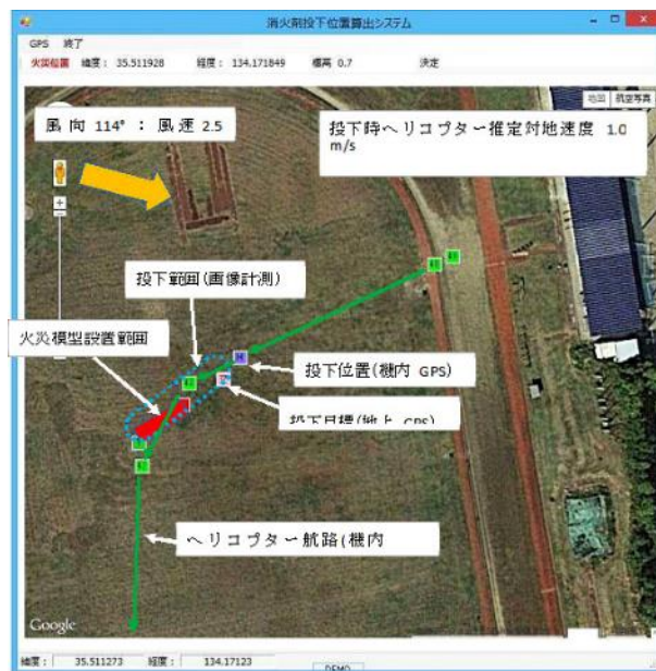
図.19 GPS の測位計測結果
