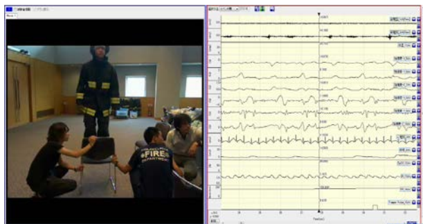
図.8 防火服の下に生体センサを装着し踏み台昇降運動をモニタリングした実験風景
