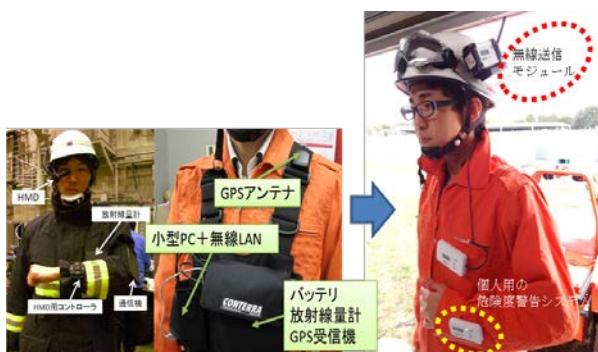
図.15 当初計画からは大幅に小型化・軽量化した撤退判断システム装備群
