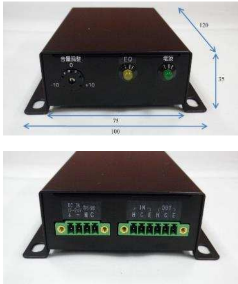
図5-2 試作装置の外観 (上) 正面の外観と寸法 (mm) (下) 背面の外観
