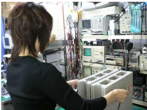
図 1 4 通信経路電波伝搬損失の測定
