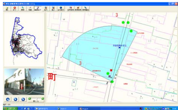
図4 現場確認用映像の表示例 (画面左下に表示された画像に対するパン操作に合わせ、視野を示した地図中の扇形が回転する)
