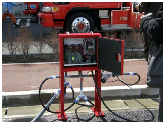
写真 6 (仮想) 救助工作車内臓型温水装置
