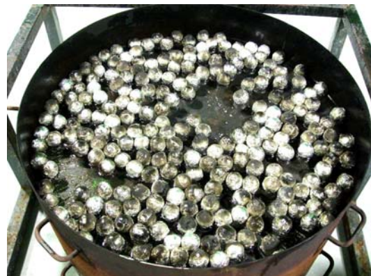
写真6 油面の 2/3 を浮子で覆う
