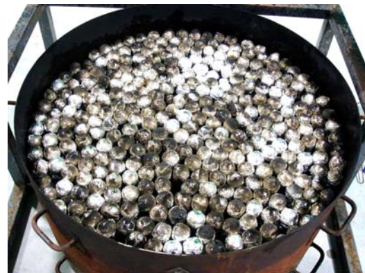
写真7 油面の 2/3 を浮子で覆う
