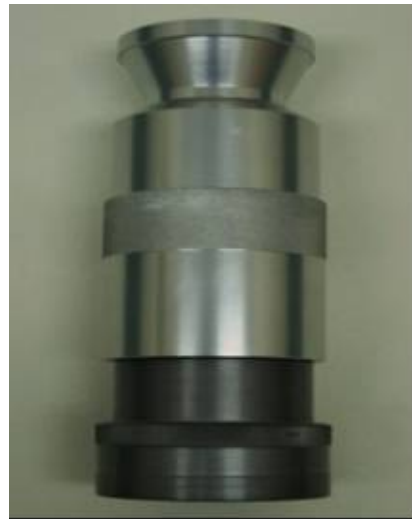
図2 「平面注水」ノズルの試作品モデルA
