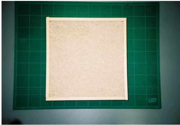
図2 奥行き 5cm×縦横 30cm の枠にはめた粒状珪藻土試料 珪藻土粒子の大きさは、長径約 3mm。
