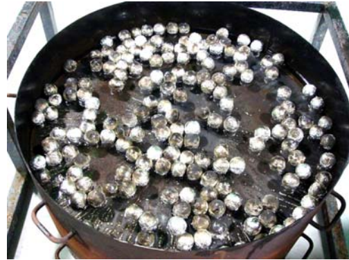
写真5 油面の 1/2 を浮子で覆う
