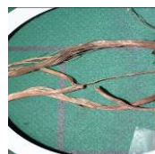
写真8 電気痕を 写真撮影
