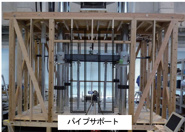
(b) パイプサポートの設置状況
