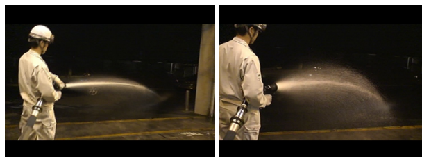
棒状放水 拡散放水 図25 内部機構性能検証
