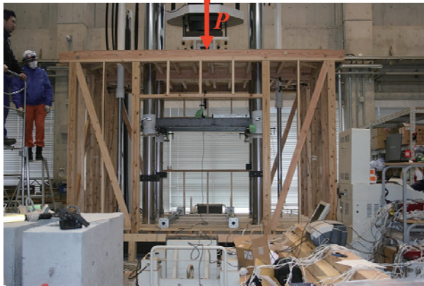
(a) 試験体と荷重 (P) の作用位置
