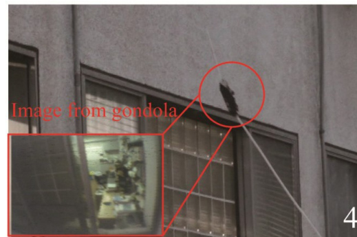
図 14 チューブ付き子機を投擲後(上図), ゴンドラ探査機で室内の画像を収集(下図)
