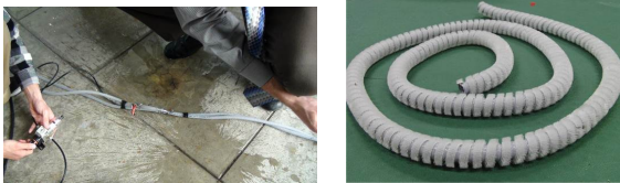
図. 21 ウォーターハンマーの実験と試作した織毛チューブ
