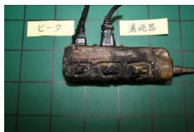
写真4 焼損した3口 テーブルタップ
