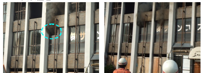
① 点火後、窓の一部が破裂
