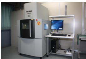
写真1 X線透過検査装置
