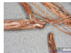
写真9 電気痕をデジタル マイクロスコープ で撮影
