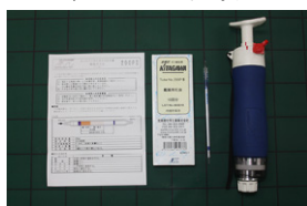
写真14 北川式ガス検知器及び検知管
