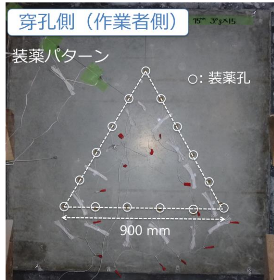
図1 RC壁供試体と装薬パターン （穿孔径16mm、孔間隔180mm）
