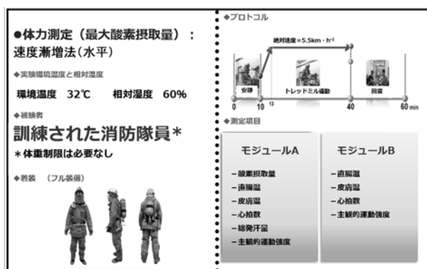
図 7. 本研究で提案する熱ストレステスト法
