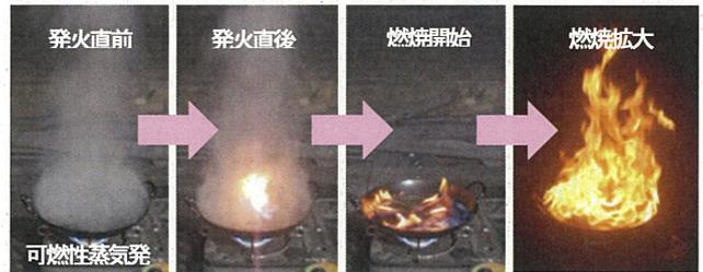
写真1 天ぷら油火災消火実験モデルの発火・燃焼の一例
