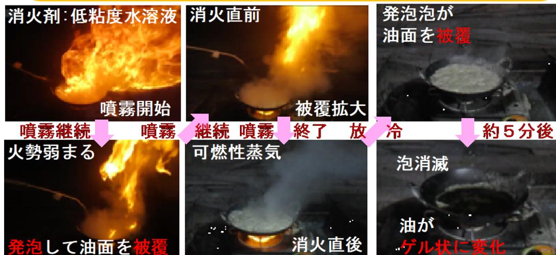
図2 液状消火剤による天ぷら油火災の消火実験
