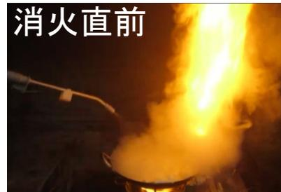
図3 液状消火剤による天ぷら油火災の消火実験
