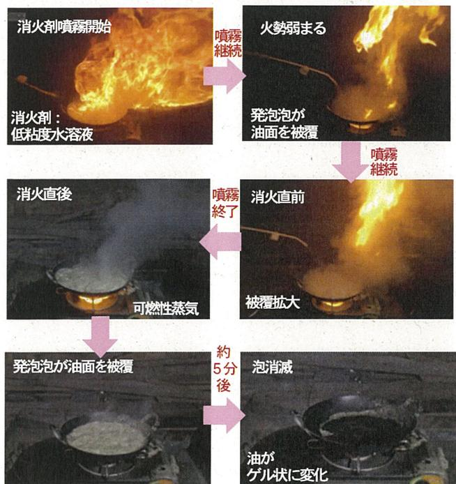
写真4 液状消火剤による天ぷら油火災の消火
