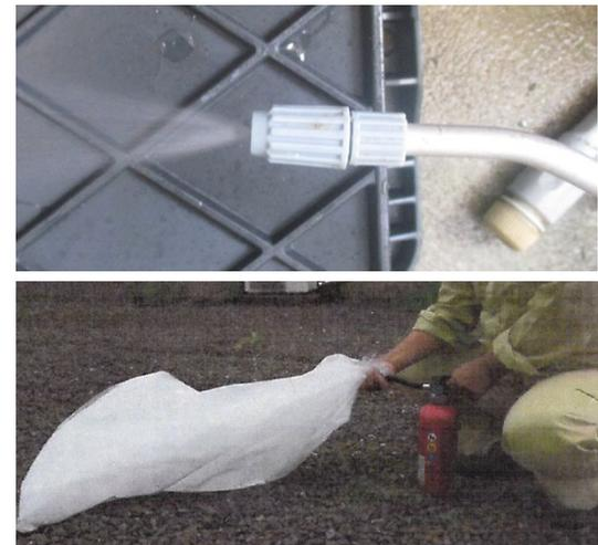
図4 ケイ酸化合物系消火剤の形態。上：液状消火剤；下：粉末消火器
