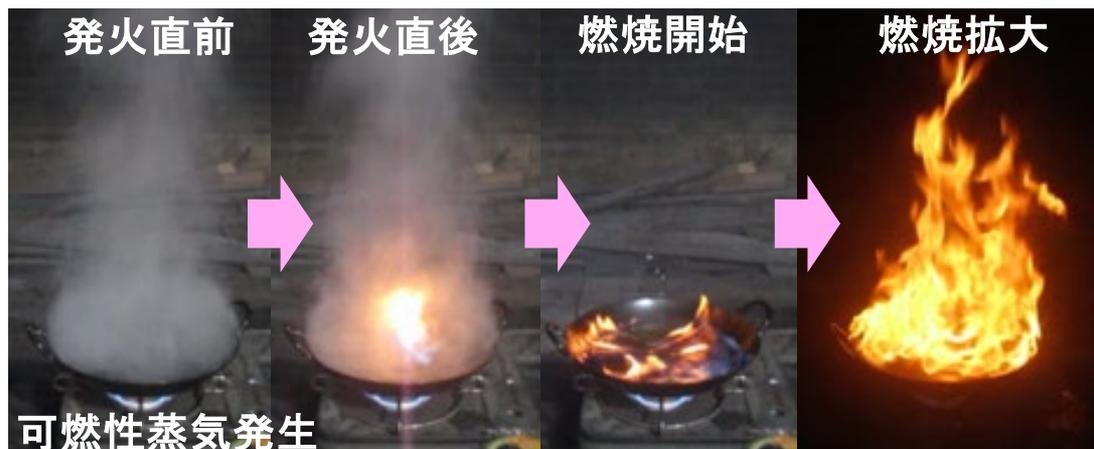
図1 天ぷら油火災の消火実験モデル
