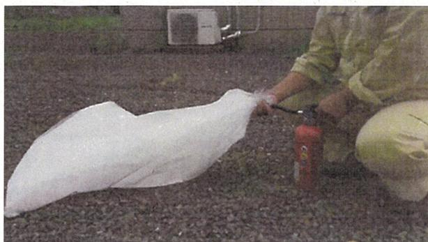
写真3 小型消火器による粉末消火剤の噴霧試験
