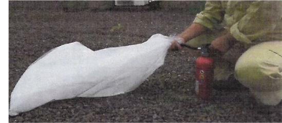
粉末消火剤の噴霧による温度低下が少なく、鍋の加熱は継続していたため再発火を繰り返した
