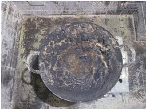
写真6 天ぷら油火災を粉末消火剤により消火した後の天ぷら鍋の様子
