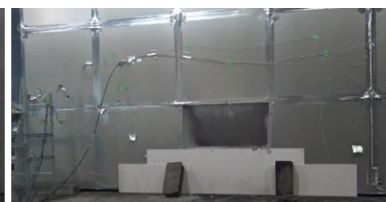
実大規模の区画を用いた消火実験
