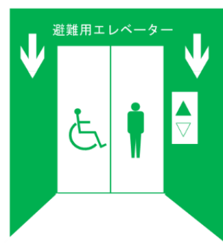
エレベーターホール 誘導標識の例
