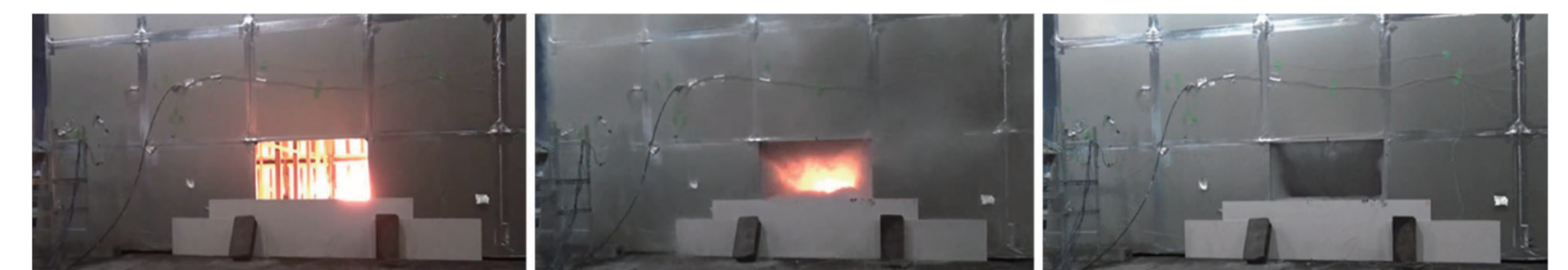
実大規模の区画を用いた消火実験
