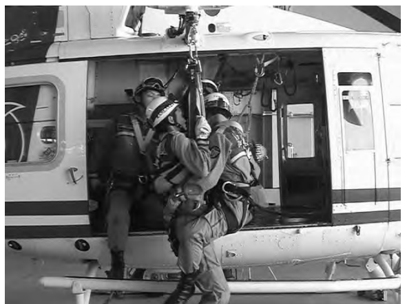
④ 航空消防隊員が体を横向きにし、片手でスキッド（ステップ）を押し、体をクリアーする。救助隊員は取手から手を離さず身体確保のみを行う。
