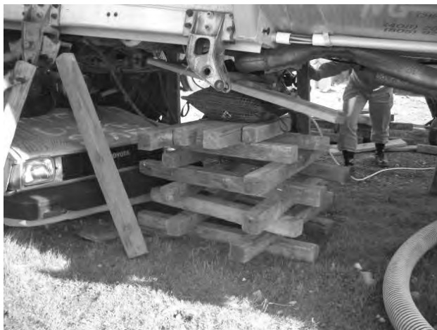
長いクリブで井形を組み、マット型空気ジャッキを挿入する。
