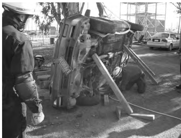
長いクリブを使用し、車両を安定させ、地面と車両の隙間にマット型空気ジャッキを挿入し救出する。
