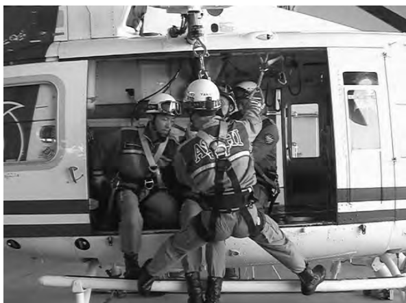
③ 航空消防隊員が機外に出る。救助隊員はサバイバースリング取手を両手で握り、ホイストが巻き上げられ自然に機外に出る。
