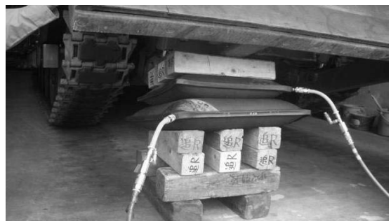
3×3クリビングで重量物を持ち上げている、上部は接点が少ない為、クリブを施している。
