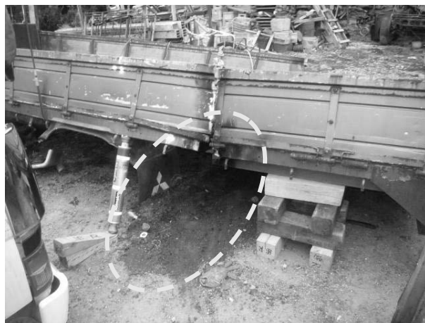
解体車両の落下事故、点線部分に要救助者が挟まれていた
