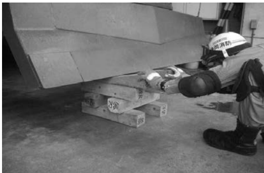
2×2クリビングで重量物(震災工作車16t)を安定させている。
