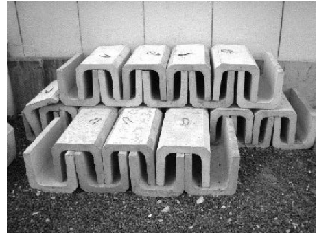
破壊基本訓練用のU字溝
