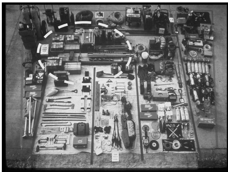
USARのHeavy Levelの資機材である、点線で囲んだ部分に様々なクリブが用意されている
