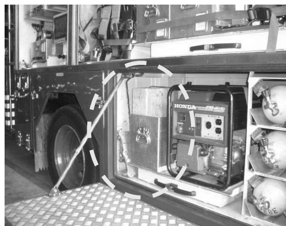
点線が、積載した「あて木」であるが、救助工作車には、この程度しか積載出来ない。
