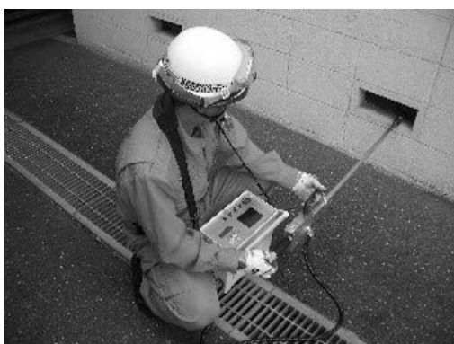
③二酸化炭素探査装置での検索状況
