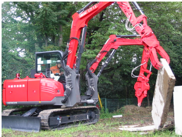
左) コンクリートスラブをグラップルでつかみ重心を確認している 右) 防災訓練でH鋼を移動させている
