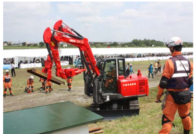
左) コンクリートスラブをグラップルでつかみ重心を確認している 右) 防災訓練でH鋼を移動させている
