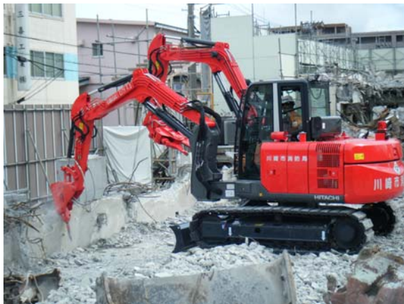
双腕作業機と救助隊員が、同時進行で壁面下部にブリーチングを開始 ブレーカーでは壁面下部に横穴を開けるのは困難
