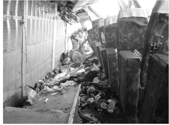
事故車両内の座席の取り外し状況
