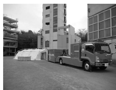
大型除染システム搭載車
