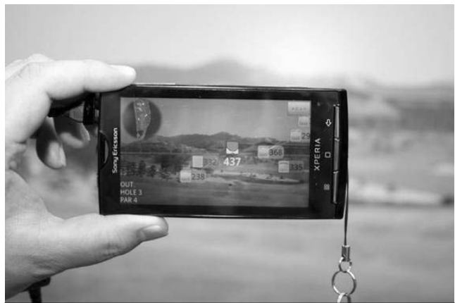
AR技術 スマートフォン等で現場を覗くと、拡張された情報が画面に表示される。写真はゴルフ場を覗きみて、距離を表している。
